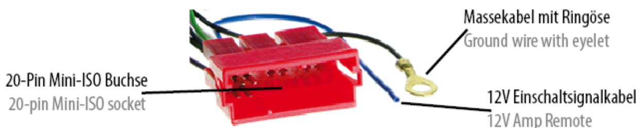
3. Schließen Sie das lose schwarze Massekabel mit der Ringöse an eine geeignete Stelle / Connect the loose black Ground wire with the eyelet to a suitable location.
