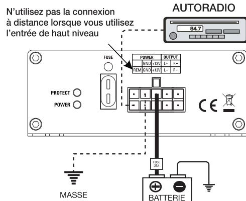
Connecter un câble de 8mm<sup>2</sup> minimum avec un porte-fusible placé à moins de 45 cm de la batterie de la voiture et reliez-le à la connexion "+12V".
