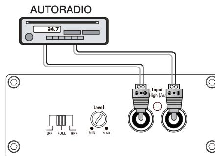
Les entrées haut niveau ne doivent être utilisées que lorsque votre autoradio ne dispose pas de sorties RCA. Connectez les sorties haut-parleur au connecteur d'entrée haut niveau de l'amplificateur. Assurez-vous d'observer les polarités pour éviter les problèmes de phase. Le fil de masse peut être connecté à la masse de l'autoradio.
