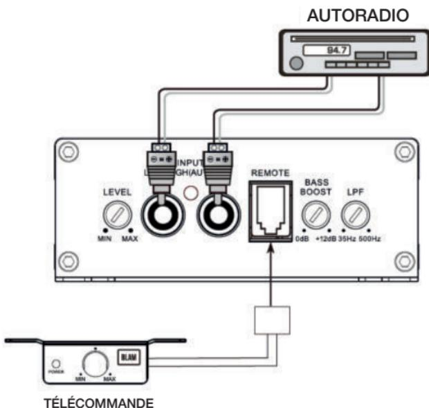
Les entrées haut niveau ne doivent être utilisées que lorsque votre autoradio ne dispose pas de sorties RCA. Connectez les sorties haut-parleur au connecteur d'entrée haut niveau de l'amplificateur. Assurez-vous d'observer les polarisés pour éviter les problèmes de phase. Le fil de masse peut-être connecté à la masse de l'autoradio.
