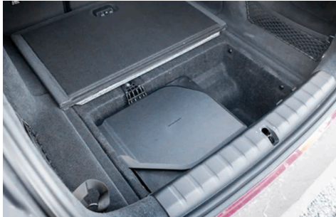
Original basskasse avbildet. Start med å ta av "dørlist" avbildet til høyre i bildet.
