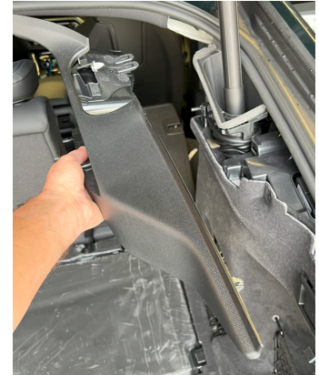
Toppdeksel må av på venstre side. 3 klips nede og 1 klips oppe.
