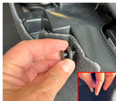
Løsne panelklips. 3 klips nede og 1 klips oppe.
