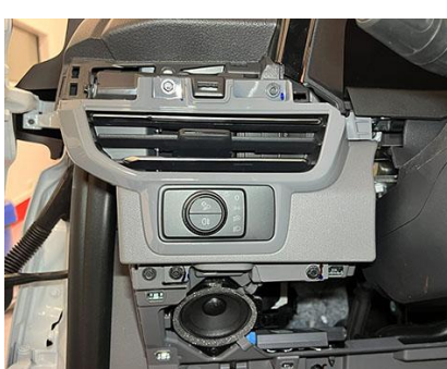
Deksel rundt luftedysse og brytere for lys skal også av, før du kommer frem til display. Skru ut displayet og legg til siden.
