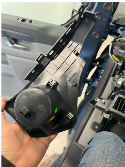
Ut med koppeholder. OBS! Bare på Ford er det koppholder. På VW er det bare et deksel der
