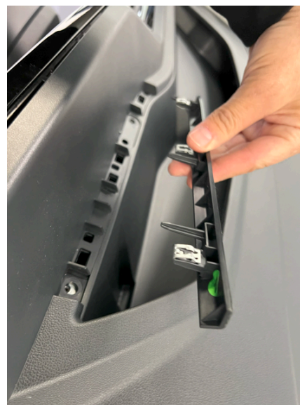
Av med list og ut med skruer bak skjerm.
