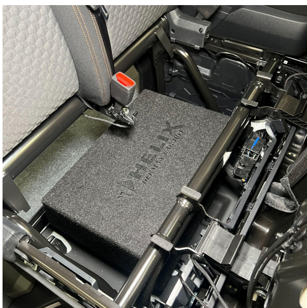
GAS MAX 6,5" basskasse ved plassering under passasjerstol 2-seter. Element oppover og gjerne bassport mot passasjerdør.
