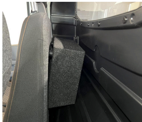
HELIX 10" basskassse ved plassering bak seterygg på 3-seter utgave.
