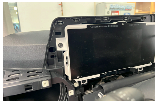
Deksel rundt luftedysse og brytere for lys skal også av, før du kommer frem til display. Skru ut displayet og legg til siden.
