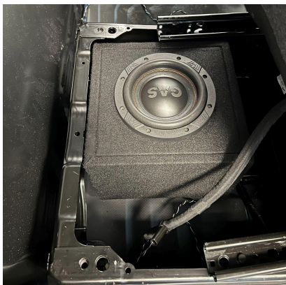
GAS MAX 6,5" basskasse ved plassering under passasjerstol 2-seter. Element oppover og gjerne bassport mot passasjerdør.
