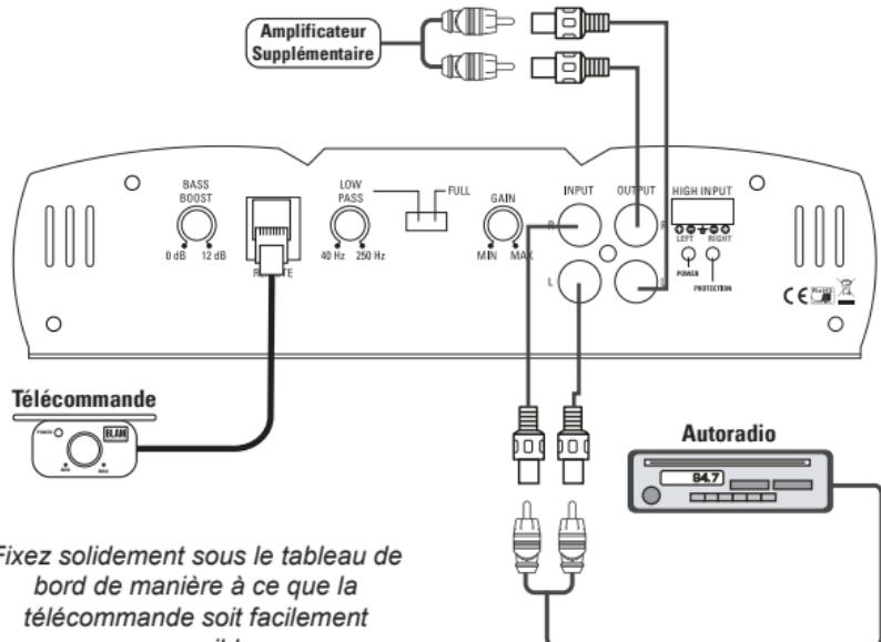
Les entrées bas niveau (RCA) sont préférables pour de meilleures performances audio, si votre autoradio est équipé de sorties RCA. Les installations dans le coffre nécessite un câble RCA d'une longueur d'environ 4 à 6 mètres tandis que les installations sous le siège et l'habitacle nécessitent un câble RCA d'une longueur d'environ 1,8 à 3,6 mètres.
