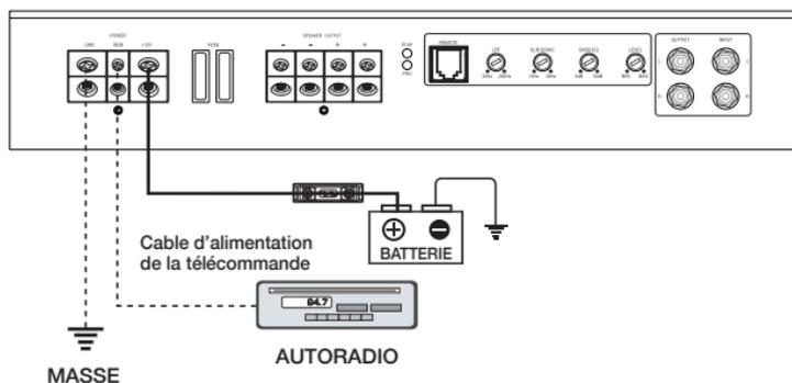
Connecter un câble de 8 mm<sup>2</sup> minimum avec un porte-fusible placé à moins de 45 cm de la batterie de la voiture et reliez-le à la connexion "+12V".
